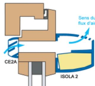
Côté intérieur, le socle de l'entrée d'air ISOLA 2 ou la rallonge acoustique ISOLA 2 (RA), est fixé par 3 vis. Montage du capot par simple emboîtement.
