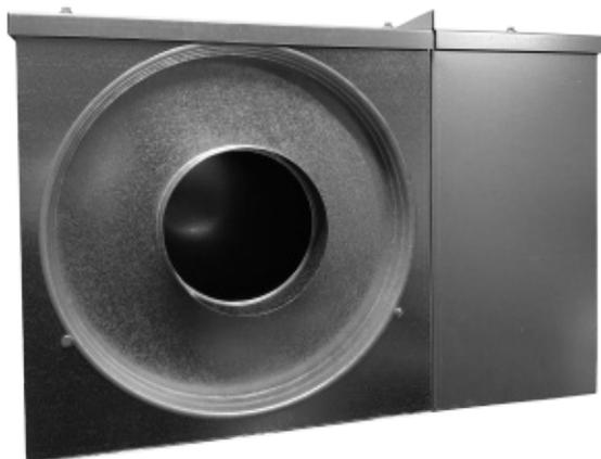
Le caisson de détente du conduit de ventilation de type CCV standard est une pièce d'adaptation en tôle d'acier galvanisée rectangulaire ou carré à sa base permettant de s'adapter à la section du conduit de ventilation de type shunt et individuel.
