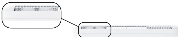
Le modèle 22 m<sup>3</sup>/h permet d'obtenir sur chantier le débit 30 m<sup>3</sup>/h en cassant soigneusement les clips sécables : casser les 2 clips marqués 22 pour obtenir 30 m<sup>3</sup>/h.
