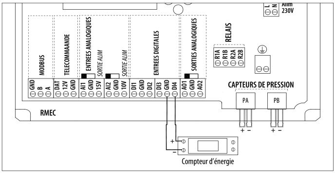
Le raccordement sur le compteur d'énergie est fonction du modèle. Voir la notice du produit utilisé.
