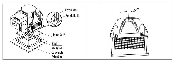
L'embase de la tourelle doit recouvrir entièrement le support pour assurer une bonne étanchéité. S'assurer que le support soit adapté au poids de l'ensemble de la machine et de ses différents accessoires. Fixer la tourelle par les trous Ø20 prévus à cet effet. L'utilisation de rondelle LL est recommandée.
