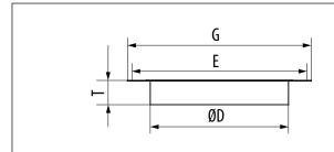
La plaque d'adaptation permet de raccorder la tourelle à un conduit circulaire. Il s'agit d'une pièce permettant le raccordement aéraulique, elle n'est pas prévu pour supporter le poids de la tourelle.
