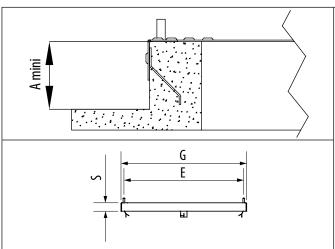
Sceller le cadre dans le support maçonné et s'assurer que les pattes de scellement soient bien noyées dans le béton.
