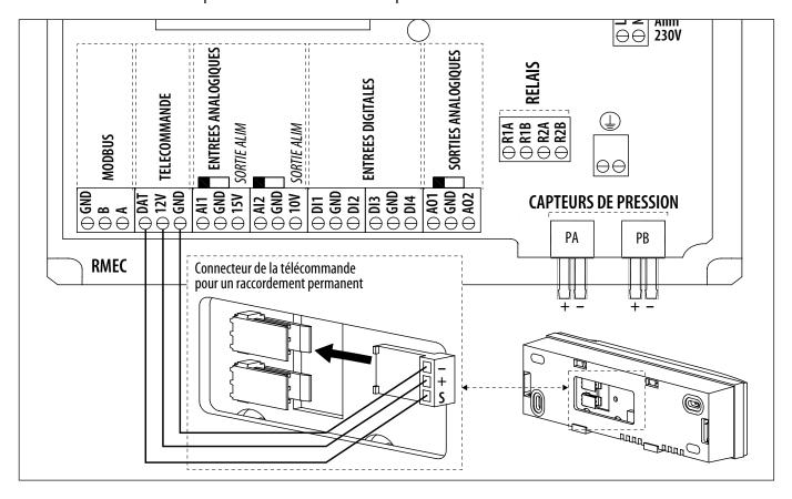
Nota: Possibilité de raccorder 2 télécommandes simultanément: une en raccordement permanent, l'autre en temporaire. Pour limiter la puissance maximale à fournir, le rétroéclairage de l'afficheur des télécommandes s'éteint automatiquement après 1 minute sans appui sur les touches.
