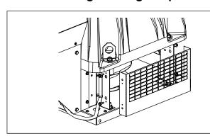
Démonter la grille en dévissant les vis autoforantes Ø4,2 (clé de 8).
